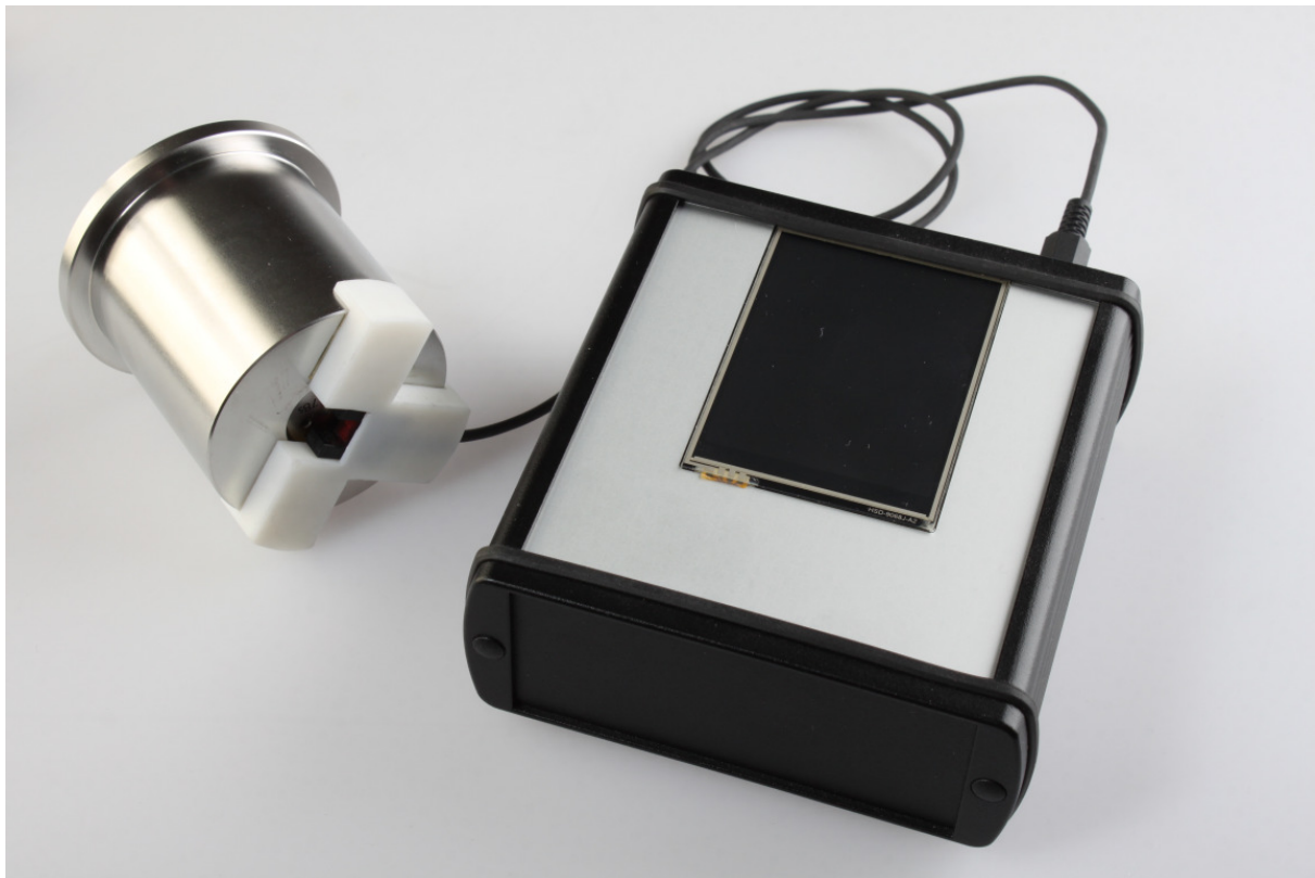
Abb: Messgerät Powdergauge 1 und Hall- und Carneytrichter
